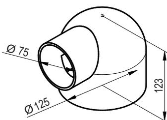
Pour tout montage où il est nécessaire de traverser la structure de construction
